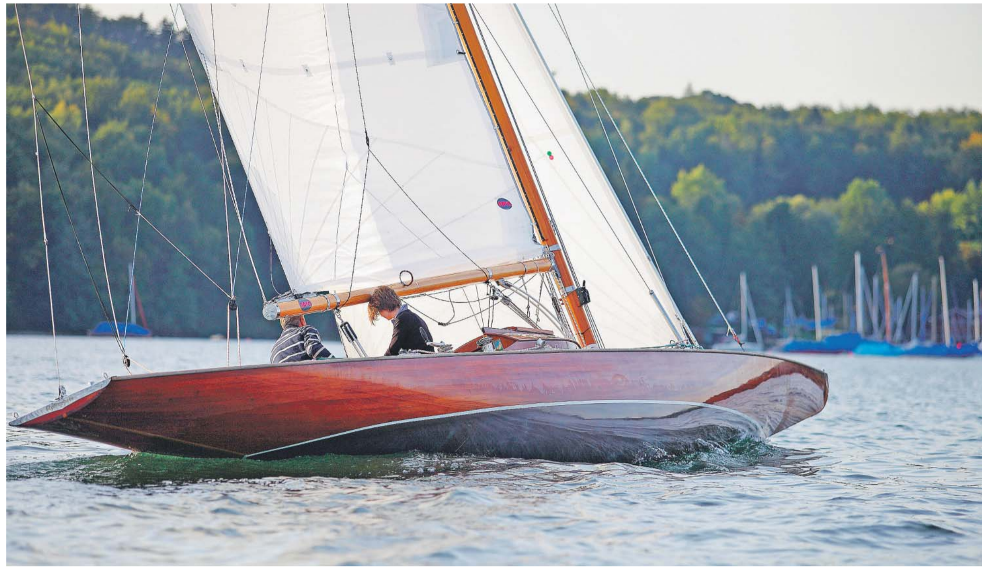
Raffinesse anno 1923: Der Schärenkreuzer „Aphrodite“ zeigt eine Spezialität des Konstrukteurs Estlander, nämlich, den vorderen Überhang des Boots besonders flach über das Wasser zum Bug zu führen (es entsteht der Eindruck bobler, eingeschnürter Linien, was aber nicht der Fall ist), so dass sich die wirksame Wasserlinie eber streckt. Estlander setzte auch auf vergleichsweise breite Hecks. Fotos Ulli Seer
